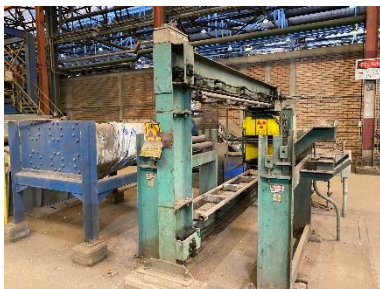
Fig. 36: Medidor de espesor.
