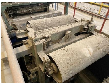
Fig. 8: Rodillos entrada acumulador
